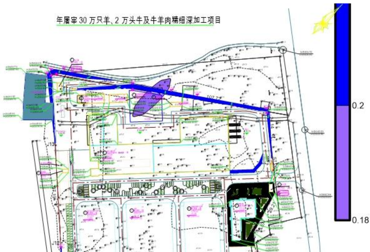
图 4-3 非正常状况下氮氮污染物注入含水层后 1000d 迁移范围图
